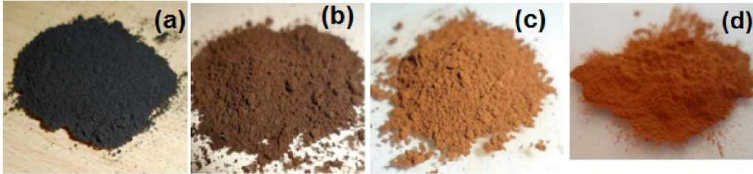
**Fig.1.** Samples synthesized: (a)  $\text{Fe}_3\text{O}_4$  (b)  $\text{Fe}_3\text{O}_4@\text{SiO}_2$  (c)  $\text{Fe}_3\text{O}_4@\text{SiO}_2@\text{KIT-6}$  (d)  $\text{Fe}_3\text{O}_4@\text{SiO}_2@\text{KIT-6-NH}_2$
